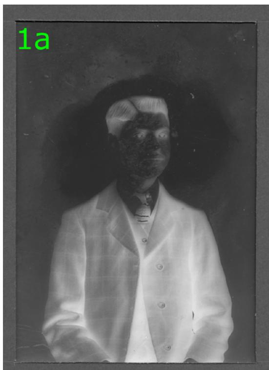
Figura 1a - sobre a cara evidência da zona onde foi aplicada *mattolina*, com alteração de reflexo da superfície da emulsão do negativo NEG003369.
