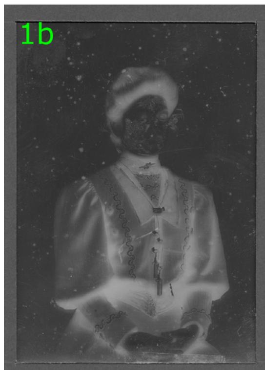
Figura 1b - corresponde ao negativo NEG003371 que se apresenta picado, defeito que ocorre na gelatina quer por formação de bolhas ou por condições deficientes de secagem da gelatina (neste a *mattolina* terá sido aplicada sobre toda a superfície).
