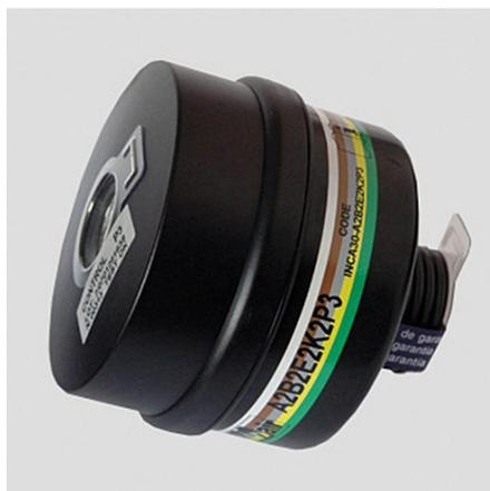
Imagem 7 – Exemplo de um filtro ABEK+P3. Proteção contra: gases e vapores orgânicos e inorgânicos; dióxido de enxofre e outros gases e vapores ácidos; amoníaco e derivados orgânicos do amoníaco; partículas sólidas e/ou líquidas e aerossóis. Extraído de Catálogo Online Killgerm®.
