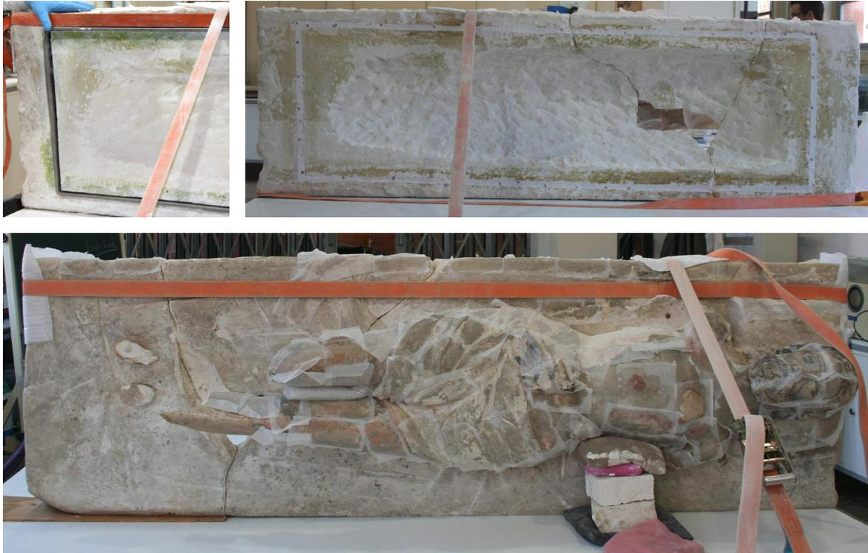
Figura 10 – Fotografias do decorrer dos trabalhos. Da esquerda para direita e em baixo, respectivamente: sulco e inserção de barra metálica; Finalização pelo tardo, após injeção da resina; Reposicionamento sobre o lado esquerdo, com justaposição de fragmentos.
